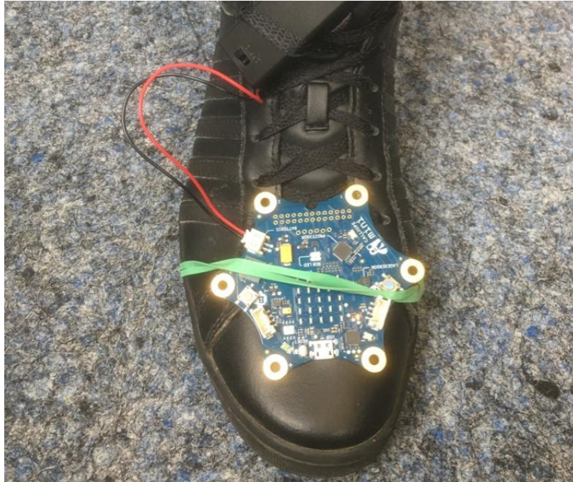
Abbildung 5: Befestigung und Ausrichtung des Calliope mini am Schuh
