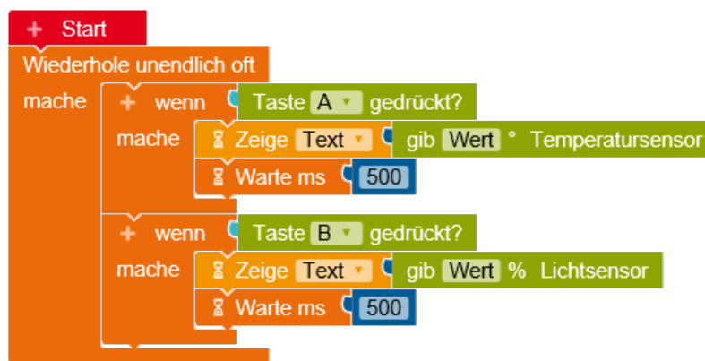
Abbildung 5: NEPO-Programm Temperatur- und Lichtsensor
